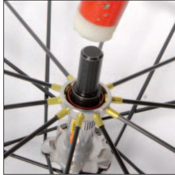
Neue Lager mithilfe des Lager-Montagewerkzeugs M40120 einbauen.
