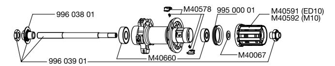
Die vordere Nabe besteht aus drei, die hintere aus zwei Haupt-Bauteilen, Sämtliche Wartungsarbeiten (Ersetzen von Achsen oder Lagern) müssen am kompletten Laufrad (Nabe, Felge und Speichen) durchgeführt werden.
