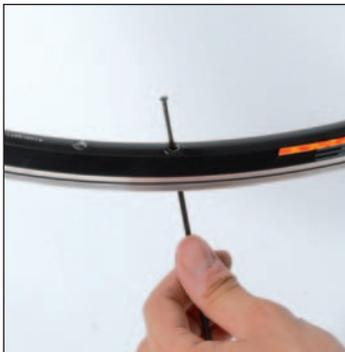
Felge mit dem Ventilloch zum Körper halten. Eine Speiche mit dem Speichenkopf voraus in die erste Felgenbohrung rechts vom Ventilloch stecken. Dann in jede zweite Bohrung eine weitere Speiche.
