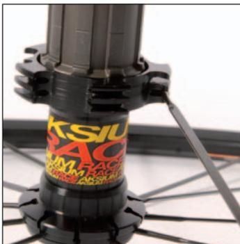
Die erste Speiche rechts vom Ventilloch ist eine Druckspeiche und wird in einen inneren Schlitz eingehängt. Danach rundum mit jeder vierten Speiche ebenso verfahren.
