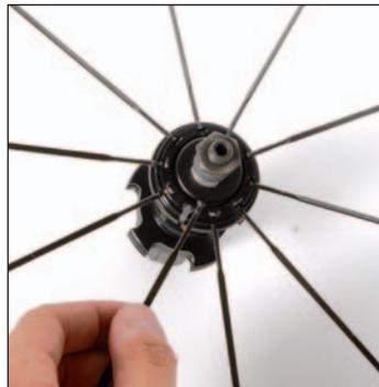
Alle Speichenköpfe rundum von der Aussenseite in den linken Nabenflansch eingehängen.
