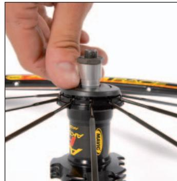
Speichen-Abdeckung am Nabenflansch einklicken. Laufrad umdrehen und die restlichen Speichen (also die längeren) rundum in die übrigen Felgenbohrungen stecken.
