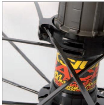
Die dritte Speiche rechts vom Ventilloch ist eine Zugspeiche und wird in einen äusseren Schlitz eingehängt. Danach rundum mit den restlichen Speichen ebenso verfahren.
