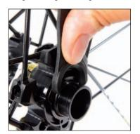
Lagereinstellschlüssel M40123 am Lagereinstellring rechts an der Nabe ansetzen.
