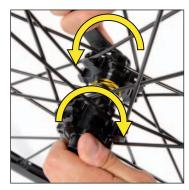
Achse wieder einbauen. Lagereinstellring handfest anziehen und wieder um eine 1/4 Umdrehung lösen.
