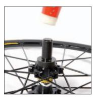
Lager mithilfe des Montagewerkzeugs M40218 austreiben und neue Lager montieren.
