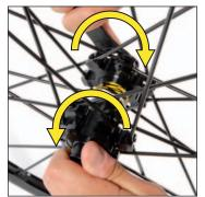
Achse von Hand auf der linken Seite festhalten und den Lagereinstellring komplett losdrehen. Achse aus dem Nabenkörper ziehen.
