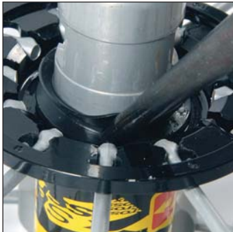
Lippendichtung mithilfe des spitzen Dorns vorsichtig wieder auf dem Freilaufkörper montieren.
