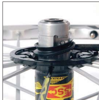
Lippendichtung vorsichtig mithilfe des spitzen Dorns demontieren.
