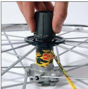
Freilaufkörper abnehmen, indem dieser gegen den Uhrzeigersinn gedreht wird.
