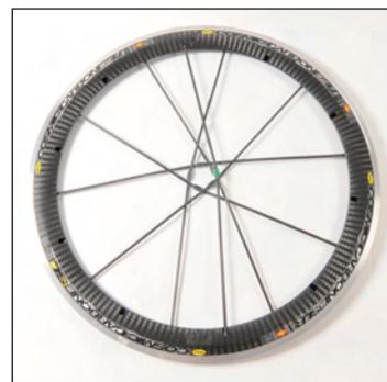
Dritte Speiche in die (gegen den Uhrzeigersinn) **9. Felgenbohrung rechts vom Ventilloch** schrauben. Anderes Ende dieser Speiche in die **19. Felgenbohrung rechts vom Ventilloch** schrauben.
