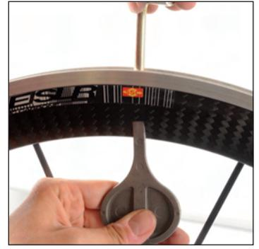
Speichen auf die gewünschte Speichen-Spannung bringen und Laufrad zentrieren. Dabei mithilfe des Speichen-Fixierschlüssels 101 295 01 die Speichenköpfe in den Carbon-Felgenflanken fixieren. **Den Fixierschlüssel dabei ohne Kraftaufwand bis zum Anschlag in die Öffnung der Carbonfelge schieben.**
