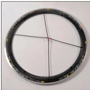
Nächste Speiche in die (gegen den Uhrzeigersinn) 5. Felgenbohrung rechts vom Ventilloch schrauben. Anderes Ende dieser Speiche in die 15. Felgenbohrung schrauben.
