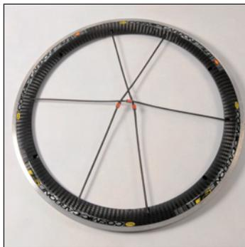
Dritte Speiche in die (gegen den Uhrzeigersinn) 9. Felgenbohrung rechts vom Ventilloch schrauben. Anderes Ende dieser Speiche in die 19. Felgenbohrung schrauben.
