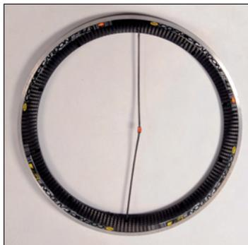
Felge mit dem Ventilloch zu sich halten. Speiche mit einem Ende in die 1. Felgenbohrung rechts vom Ventilloch schrauben. Anderes Ende dieser Speiche in die (im Uhrzeigersinn) 11. Felgenbohrung schrauben.
