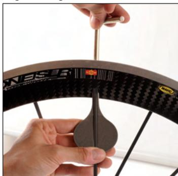
Speichen auf die gewünschte Speichen-Spannung bringen und Lauftrad zentrieren. Dabei mithilfe des Speichen-Fixierschlüssels 101 295 01 die Speichenköpfe in den Carbon-Felgenflanken fixieren. **Den Fixierschlüssel dabei ohne Kraftaufwand bis zum Anschlag in die Öffnung der Carbonfelge schieben.**
