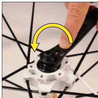
Lagereinstellung mithilfe des Multifunktions-Werkzeugs 325 423 01 vollständig losdrehen.
