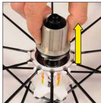
Jetzt können Achse und Freilaufkörper aus der Nabe gezogen werden.
