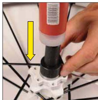
Das neue linke Nabenlager mithilfe des Lager-Montagewerkzeugs M40119 einbauen.
