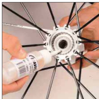
Nabenkörper reinigen und mit etwas Mavic-Mineralöl M40122 schmieren (je 1 Tropfen in drei Verzahnungen genügt). Achse und Freilaufkörper wieder in die Nabe einsetzen.
