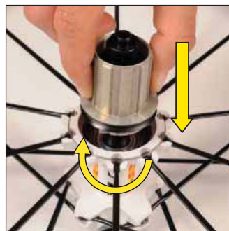
Freilaufkörper vorsichtig ins Nabengehäuse drücken. Dabei gegen den Uhrzeigersinn drehen
