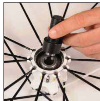
Das neue rechte Lager zusammen mit der Dichtscheibe des linken Nabenlagers positionieren und mithilfe des Lager-Montagewerkzeugs 996 901 01 einbauen.
