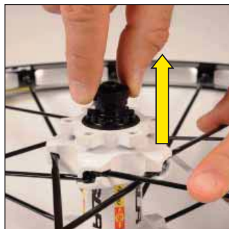
Linken Achsstummel von der Nabe abziehen.
