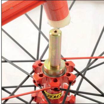
Neue Lager mithilfe des Lager-Montagewerkzeugs 996 887 01 einbauen.
