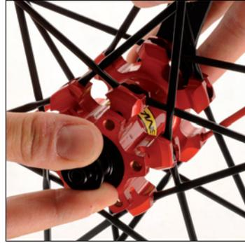
Achse von links in die Nabe stecken. Lagereinstellring mithilfe des Lagereinstellschlüssels aufschrauben. Achse dabei von Hand fixieren.
