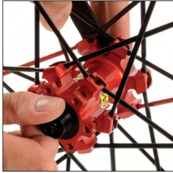
Lagereinstellschlüssel M40123 am rechten Lagereinstellring ansetzen.
