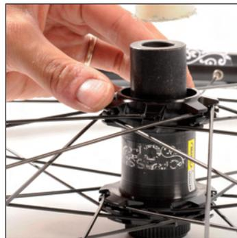
Neues Lager für die linke Seite von rechts in die Nabe setzen und mithilfe des Lager-Montagewerkzeugs M40218 sowie eines Rohrstücks einbauen.
