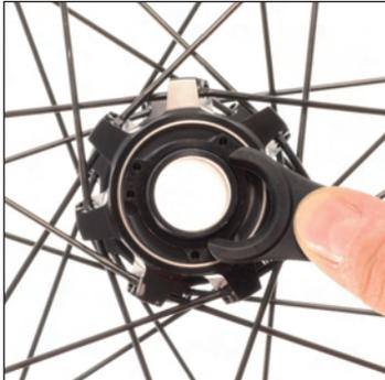
Lagereinstellschlüssel M40123 am Lagereinstellring rechts an der Nabe ansetzen.
