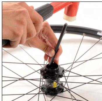
Linkes Nabenlager mithilfe eines Lager-Demontagewerkzeugs nach rechts aus der Nabe treiben.
