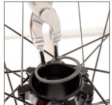
Sicherungsring von rechts mithilfe der Segerring-Zange einbauen.
