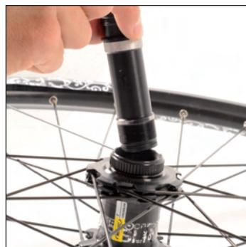
Achse von links in die Nabe stecken. Beim Crossmax SX 09 darauf achten, dass die Lagerbuchse korrekt positioniert ist.
