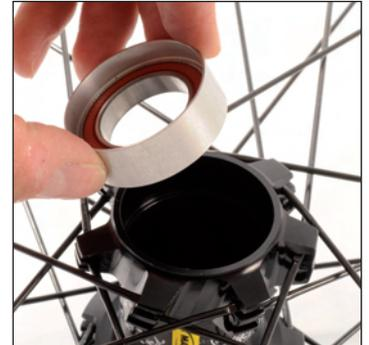
Rechtes Lager austreiben. Falls der Distanzring, in dem das Lager sitzt, zusammen mit dem Lager demontiert wird, diesen vom Lager abnehmen.
