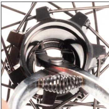
Sicherungsring von rechts mithilfe der Segerring-Zange herausnehmen.
