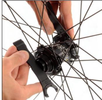
Lagereinstellring mit dem Lagereinstellschlüssel M40123 fixieren. Achse auf der linken Seite von Hand (Crossmax SX) oder mithilfe eines zweiten Lagereinstellschlüssels M40123, der in den Schlitz der (Crossline-)Achse gesteckt wird, losdrehen.
