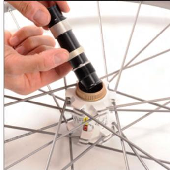
Achse herausnehmen. Beim Crossmax SX aufpassen, dass die Lagerbuchse auf der Achse nicht verrutscht.
