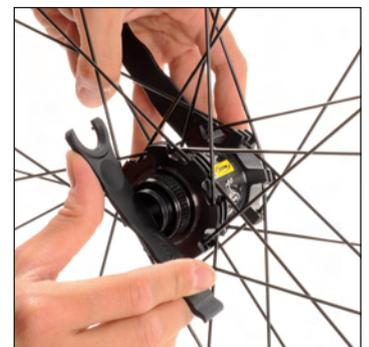
Lagereinstellung mithilfe des Lagereinstellschlüssels M40123 aufschrauben, bis er ans Lager stößt, und dann wieder um 1/4 Umdrehung lösen. Achse dabei von Hand (Crossmax SX) oder mithilfe eines zweiten Lagereinstellschlüssels M40123, der in den Schlitz der (Crossline-)Achse gesteckt wird, fixieren.
