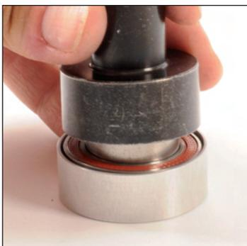
Falls beim Lagerausbau der rechte Distanzring mit demontiert wurde, jetzt das neue rechte Lager mithilfe des Lager-Montagewerkzeugs M40217 in den Distanzring einpressen.
