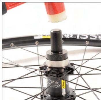
Rechtes Lager samt Distanzring mithilfe des Lager-Montagewerkzeugs M40217 einpressen.
