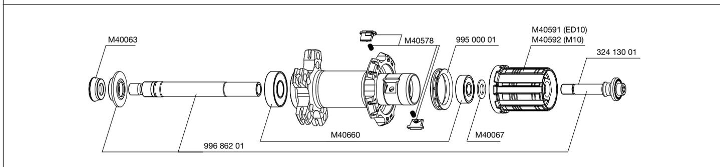
Die vordere Nabe besteht aus drei Haupt-Bauteilen. Sämtliche Wartungsarbeiten (Ersetzen von Achsen oder Lagern) müssen am kompletten Laufrad (Nabe, Felge und Speichen) durchgeführt werden.
