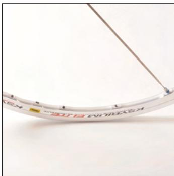
Eine Speiche bis zum Ansatz der Verdrehschutz-Beschichtung des Speichennippels in die 3. Felgenbohrung rechts vom Ventilloch schrauben. Diesen Vorgang mit den restlichen Speichen rundum in jede vierte Felgenbohrung durchführen.
