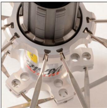
Laufrad wenden. Rundum die (kurzen) Speichen in die restlichen Felgenbohrungen schrauben und die Speichenköpfe in die entsprechenden Nuten im rechten Nabenflansch einhängen.
