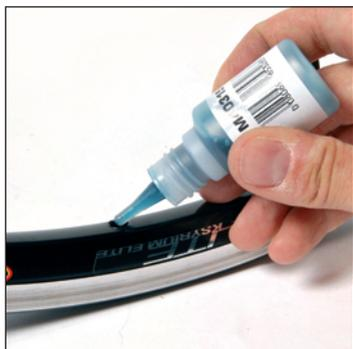
Je einen Tropfen Mavic-Schraubensicherung M40315 auf die Gewinde jeder Felgenbohrung geben.
