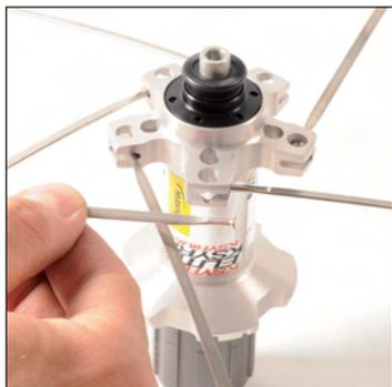
Den Kopf einer Zugspeiche unter die erste Druckspeiche, dann über die zweite Druckspeiche ziehen und in den entsprechenden Schlitz des linken Nabenflansches einhängen.
