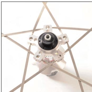
Den Speichennippel dieser Speiche in die entsprechende Felgenbohrung schrauben. Diesen Vorgang mit den restlichen Zugspeichen rundum auf der linken Seite durchführen.
