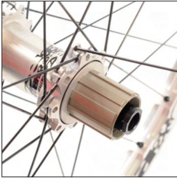
Zum Einlegen einer Speiche am inneren Nabenflansch diese mit dem Speichenkopf nach innen parallel zur Nabenachse halten.
