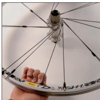
Den Speichennippel einer **Druckspeiche** (Speichenkopf am inneren Nabenflansch) bis zum Ansatz der Verdrehenschutz-Beschichtung in die **1. Felgenbohrung** rechts vom Ventilloch schrauben.
