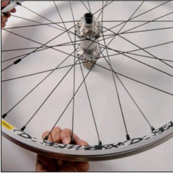
Den Speichennippel einer **Druckspeiche** (Speichenkopf am **äußeren** Nabenflansch) bis zum Ansatz der Verdrehschutz-Beschichtung in die **3.** Felgenbohrung rechts vom Ventilloch schrauben.
