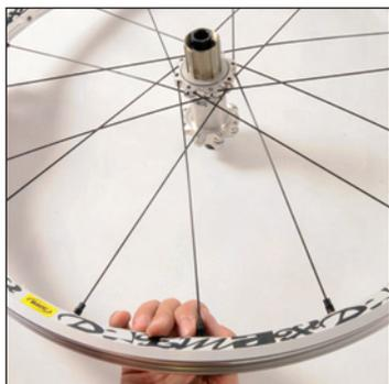
Den Speichennippel einer **Zugspeiche** (Speichenkopf am **äusseren** Nabenflansch) bis zum Ansatz der Verdrehenschutz-Beschichtung in die **3. Felgenbohrung** rechts vom Ventilloch schrauben.
