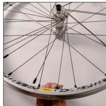
Den Speichennippel einer **Zugspeiche** (Speichenkopf am **inneren** Nabenflansch) bis zum Ansatz der Verdrehenschutz-Beschichtung in die **1. Felgenbohrung** rechts vom Ventilloch schrauben.
