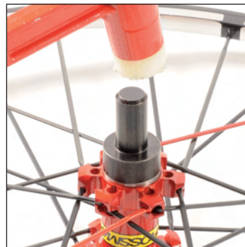
Neues rechtes Nabenlager mithilfe des Lager-Montagewerkzeugs M40218 einbauen.
