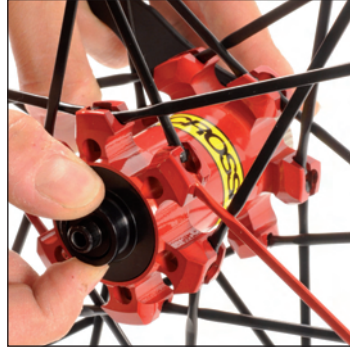
Lagereinstellring mithilfe des Lagereinstellschlüssels M40123 fixieren. Achse von Hand auf der rechten Seite losdrehen und herausnehmen.
