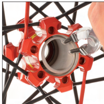
Sicherungsring von rechts mithilfe der Segerring-Zange einbauen.
