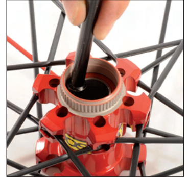
Linkes Nabenlager mithilfe eines Lager-Demontagewerkzeugs nach rechts aus der Nabe treiben.
