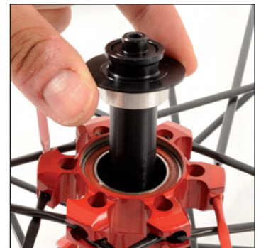
Achse von rechts in die Nabe stecken. Lagereinstellring mithilfe des Lagereinstellschlüssels aufschrauben, bis er ans Lager stößt, und dann wieder um ¼ Umdrehung lösen.
