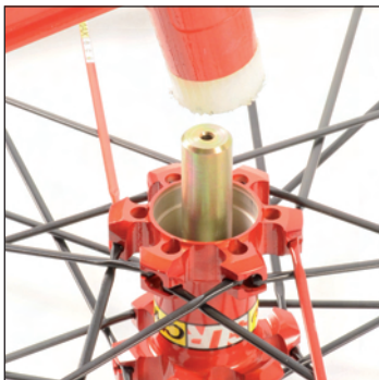
Neues Lager für die linke Seite (das mit dem kleineren Durchmesser) von rechts in die Nabe setzen und mithilfe des Lager-Montagewerkzeugs 996 887 01 einbauen.
