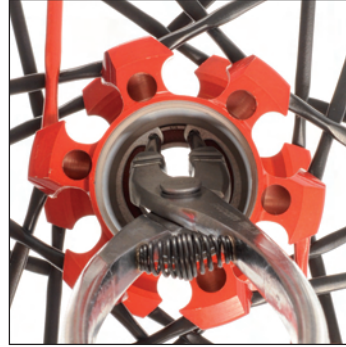
Rechtes Nabenlager austreiben. Sicherungsring von rechts mithilfe der Segerring-Zange herausnehmen.
