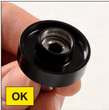
Laufrad-Halteschraube von der abgeflachten Seite auf die Distanzscheibe stecken (siehe Foto).
