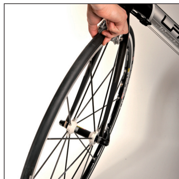
Überprüfen, ob Lagerspiel auftritt.
