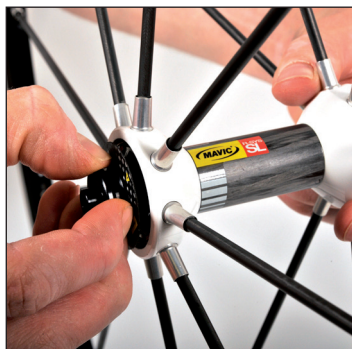
Achsstummel auf der Seite mit Dekor (am Nabenkörper) von der Achse abziehen.
