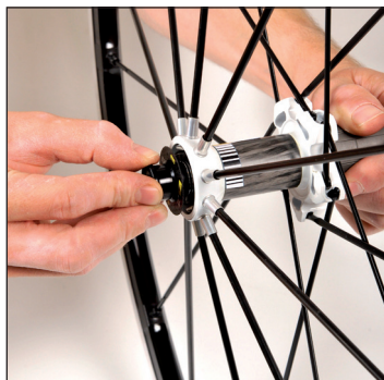
Achsstummel von der linken Seite der Achse abziehen.
