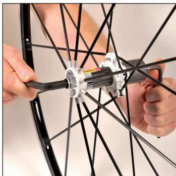
5-mm-Inbusschlüssel von rechts und 10-mm-Inbusschlüssel von links in die Achse stecken. Verschraubung lösen.
