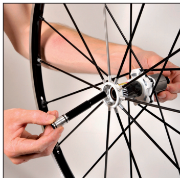
Neue Achse einsetzen und verschrauben (Anzugs-Drehmoment: 15 Nm).
