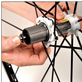
Achse nach links aus dem Nabenkörper drücken.
