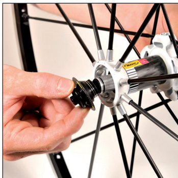
Passenden Achsstummel ermitteln, wie im Kapitel „Lagerspiel einstellen an Naben mit QRM SL-Lagerung“ beschrieben.
