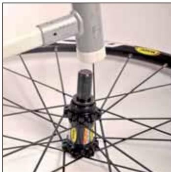
Von links mithilfe des Lager-Demontagewerkzeugs 108 850 01 das linke Nabenlager nach rechts aus der Nabe treiben.
