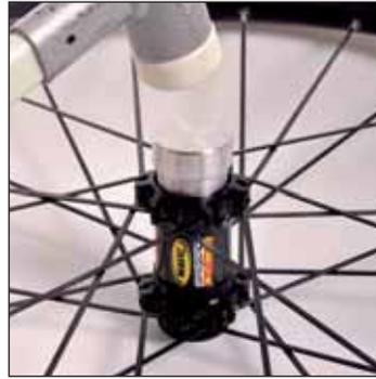
Mithilfe des Lager-Montagewerkzeugs 996 887 01 das neue rechte Lager einbauen.
