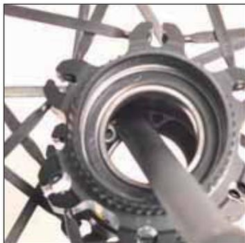
Lager-Austreiber von links in die Nabe stecken und rechtes Nabenlager austreiben. Segerring beim Lager dabei nicht beschädigen.
