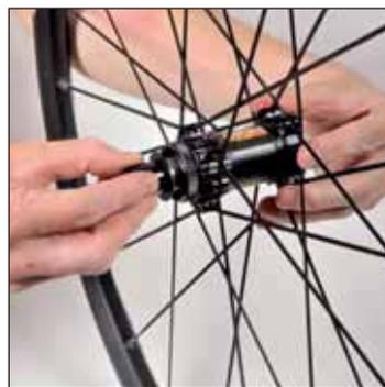
Achse nach links aus dem Nabenkörper ziehen.
