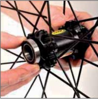
Neues linkes Lager von rechts in die Nabe einsetzen und mithilfe des Lager-Montagewerkzeugs 996 887 01 einbauen.
