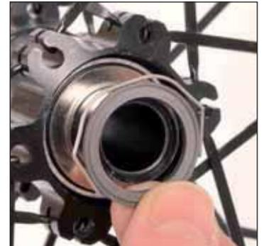
Konusscheibe und Federdraht von rechts so einbauen, dass die konische Seite nach innen und die vertiefte Seite nach aussen zeigen.
