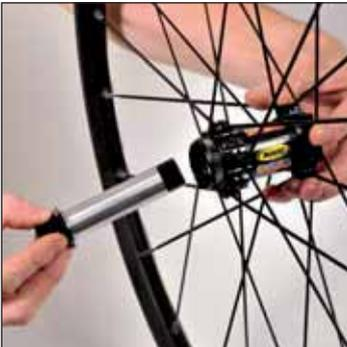
Achse von links in den Nabenkörper stecken.
