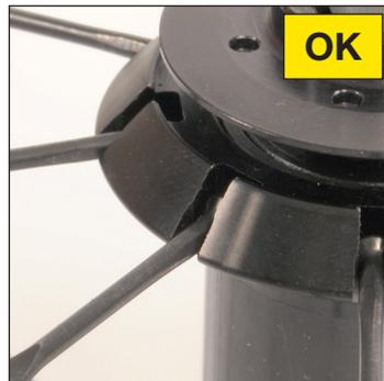
Speichennippel rundum gleichmässig anziehen (1 Umdrehung je Speiche bei jedem Durchgang). Dabei darauf achten, dass die Speichenköpfe korrekt an den Nabenflanschen eingehängt sind (Speichenköpfe links komplett in der Nut), damit diese sich weder ungewollt aushängen noch die Nabe beschädigen können.
