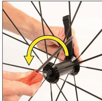
Speichen vorbereiten: Speichen rundum bis zum Ansatz der Schraubensicherung einschrauben.
