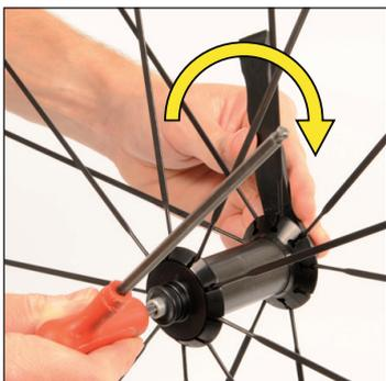
Mithilfe des Inbusschlüssels und des Lagereinstellschlüssels M40123 die Lagereinstell-Kappe im Uhrzeigersinn festschrauben – und dann wieder um eine halbe Umdrehung zurückdrehen.
