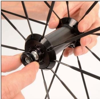
Achsstummel auf der Seite der Nabe, auf der sich die Lager-Einstellkappe befindet, von Hand abziehen.
