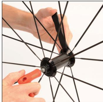
5-mm-Inbusschlüssel auf der Gegenseite in die Achse stecken. Lagereinstellkappe mithilfe des Lagereinstellschlüssels M40123 fixieren. Achsverschraubung durch Drehen des Inbusschlüssels um etwa 5 Umdrehungen gegen den Uhrzeigersinn lösen.
