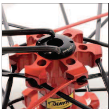
Lager-Abdeckkappe mithilfe des Stiftschlüssels aufschrauben (Anzugs-Drehmoment: 9 Nm).
