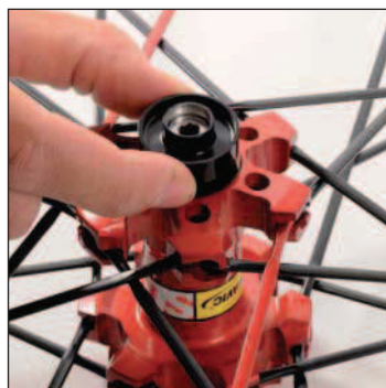
Distanzscheibe und Laufrad-Halteschraube abnehmen.
