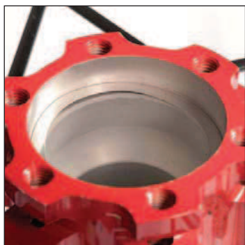
Lagerspiel mittels einer oder mehrerer Distanzscheiben (Kit 127 590 01 enthält 5 Stück) ausgleichen.
