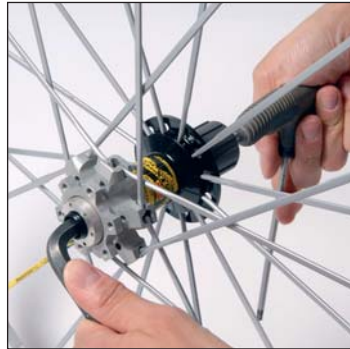
10-mm-Inbusschlüssel von links und 5-mm-Inbusschlüssel von rechts in die Achse stecken und Verschraubung lösen.
