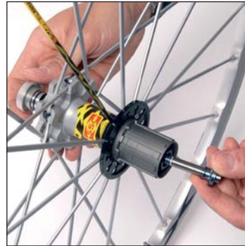
Rechten Achsstumpf aus dem Nabenkörper ziehen, dann Achse nach links aus dem Nabenkörper ziehen.
