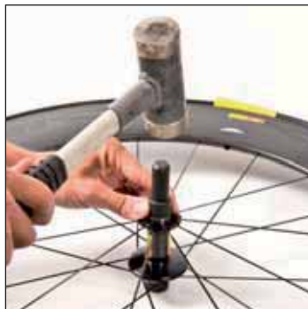
Neues Lager links mit dem Montagewerkzeug M40120 einbauen.
