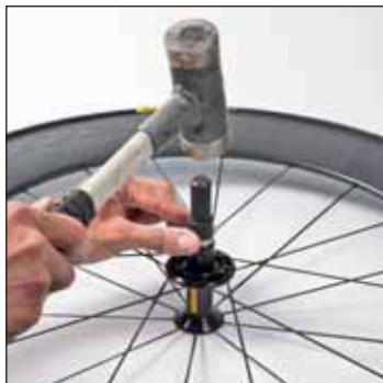
Neues Lager rechts mit dem Montagewerkzeug 351 266 01 einbauen.
