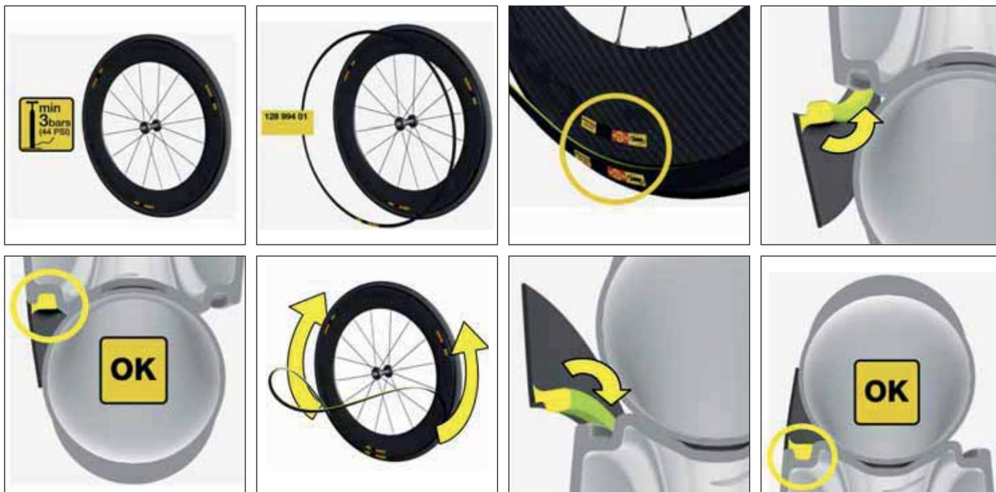
Dieselben Arbeitsschritte mit dem zweiten Aero-Blade durchführen. Dann Reifen auf den gewünschten Luftdruck (6 bis 11 bar) aufpumpen.
