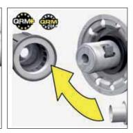
Die bisherigen M10- (M40592) und ED11-Freilaufkörper (M40591) mit 8 mm Lager-Innendurchmesser und schwarzer Lager-Abdeckung sind nicht mit den neuen Laufrädern ab Modelljahr 2013 kompatibel.
