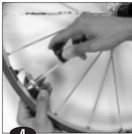
**ACHTUNG:** Jede Änderung der Speichenspannung hat grossen Einfluss auf die Zentrierung des Laufrades. Im Bereich der gewünschten Speichenspannung kann eine 1/4-Drehung des Speichennippels die Felge um bis zu 0,3 mm seitlich auslenken.
