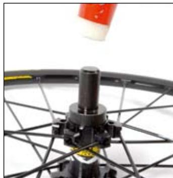
ベアリング取り外し用キット M40218 を使用して古いベアリングを外し、新しいベアリングを取り付けます。
