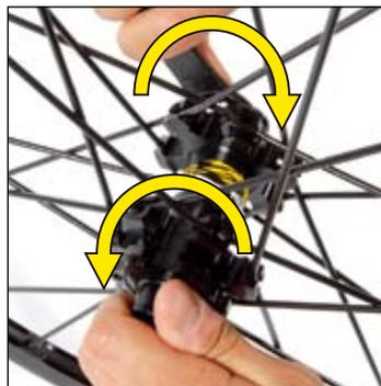
ディスク側のアクスルを手で固定して、ハブレンチで調整ナットを完全に取外します。ハブアクスルを取り外します。
