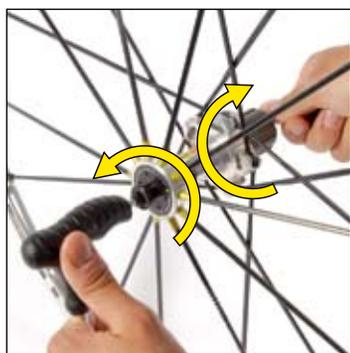
5 mm アーレンキーをアクスルの両端に差し込み、アクスルのフリーホイール側の端のネジ（アクスルエンドスクリュー）を取り外します。
