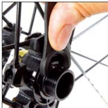
ハブレンチ M40123 の端のつまみを、反ディスク側の調整ナットの穴に入れます。
