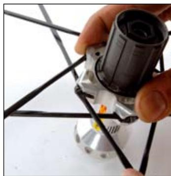
スポークのヘッドをハブスロットに差し込みます。ノントラクションスポークのヘッドはスロットの内側の溝に差し込み、トラクションスポークのヘッドは外側の溝に差し込む必要があります。
