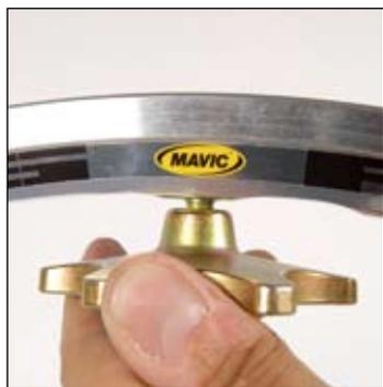
トラコンプスポークのニップルを残りのリム穴で、スレッドロックが見えなくなるまで締め付けます。
