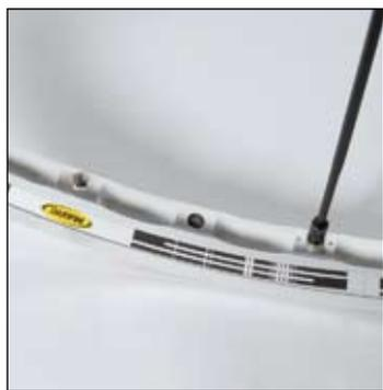
ジラルスポークのニップルをバルブ穴の右の最初の穴に 2 回転分ねじ込み、その後、すべてのジラルスポークでリムの穴に、1 つおきに同様にねじ込みます。
