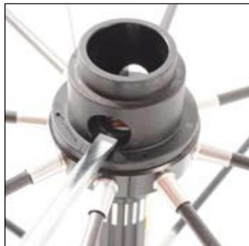
ドライバーの先端をトラコンプリングツールの穴に通します。
