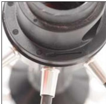
トラコンプリングツール 996 080 01 を、ツール上のドライバーの絵が見えるようにしてハブの上に乗せます。
