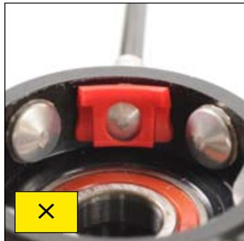
2 個のクリップを 180° 反対側のスポークヘッドの上に置きます (このときの赤いクリップの向きに注意してください)。
