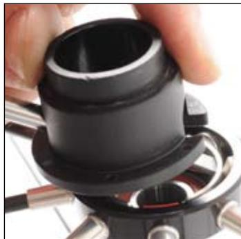
トラコンプリングツールに通したドライバーの先端を、ちょうど2つのクリップの間になるようにトラコンプリングの溝に入れます。
