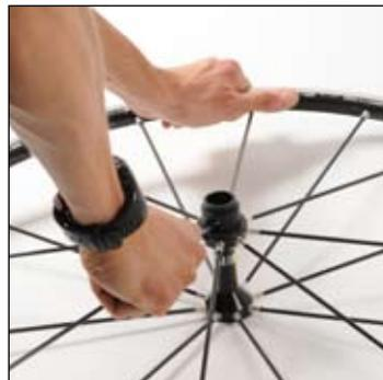
ドライバーの握りを下に押し、トラコンプリングを押し出します。この時、逆の手の平でツールを押さえておきます。
