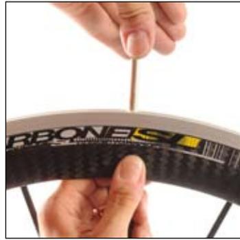
カーボンリムフランジの上からスポークヘッドを親指で押さえて、交換したスポークを取り付けます。
