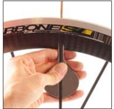
カーボンリムフランジ内のスポークヘッドを固定ツール (101 295 01) で押さえて、ホイールのテンションを最終的に調整します。この固定ツールは、十分にスペースがある方から通してください。また、無理に押し込まないようにしてください。
