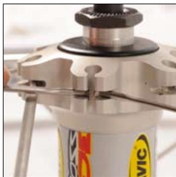
スポークヘッドをハブのスロットに差し込み、スポークがブレーキングスポークになるようにします。
