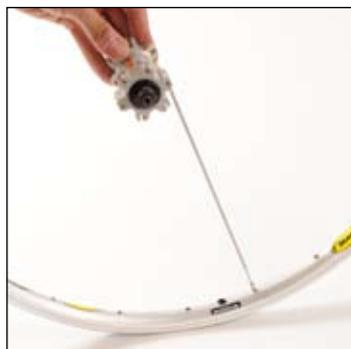
バルブの穴を手前にして、バルブ穴の右の最初のスポーク穴にスポークを差し込み、ニップルを2回転分締めます。この手順をディスク側で、6本のノンブレーキングスポークに対して繰り返します。
