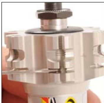
スポークヘッドをハブのスロットに差し込み、スポークがノンブレーキングスポークになるようにします。
