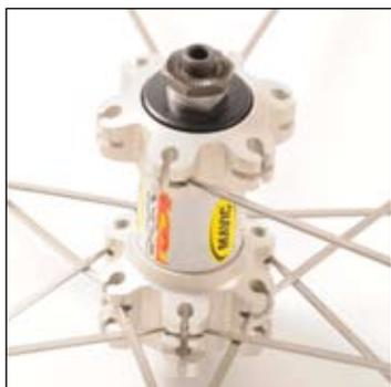
ホイールを裏返します。スポークヘッドをハブのスロットに差し込み、スポークがノンブレーキングスポークになるようにします。
