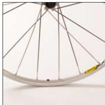
バルブの穴を手前にして、バルブ穴の右の最初の穴にスポークを差し込み、ニップルを2回転分締めます。この手順を反ディスク側で、6本のブレーキングスポークに対して繰り返します。
