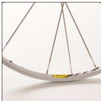
バルブの穴を手前にして、バルブ穴の右の3番目のスポーク穴にスポークを差し込み、ニップルを2回転分締めます。この手順を反ディスク側で、6本のノンブレーキングスポークに対して繰り返します。
