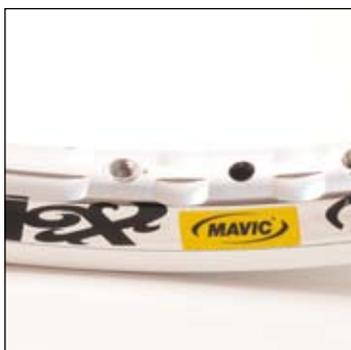
バルブ穴を手前にして、目印のコブがバルブ穴の左にくるようにリムを回します。
