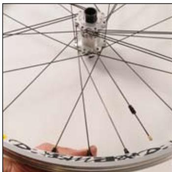
ノンブレーキングスポーク(ハブアックスルの右にあるスロットの内側部分)のニップルをバルブ穴の右の3番目のスポーク穴にロックされるまで回します。
