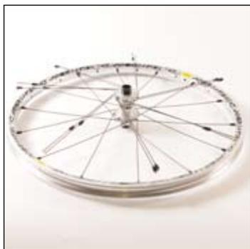
ホイールを裏返し、反ディスク側のすべてのスポークを、最初の4つの手順で説明した方法で差し込みます。
