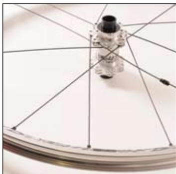
ブレーキングスポーク(ハブアックスルの左にあるスロットの外側部分)のニップルをバルブ穴の右の3番目のスポーク穴にロックされるまで回します。この手順を、スロットの外側部分に差し込まれたすべてのブレーキングスポークについて、リムの4つ目のスポーク穴ごとに実行します。
