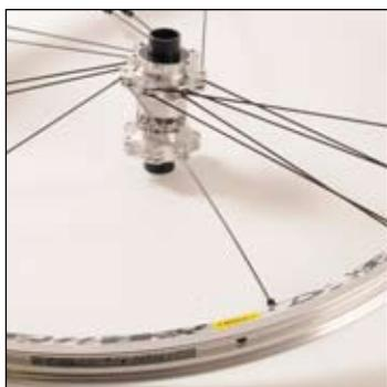
ノンブレーキングスポーク(ハブアックスルの左にあるスロットの内側部分)のニップルをバルブ穴の右の最初のスポーク穴にロックされるまで回します。
