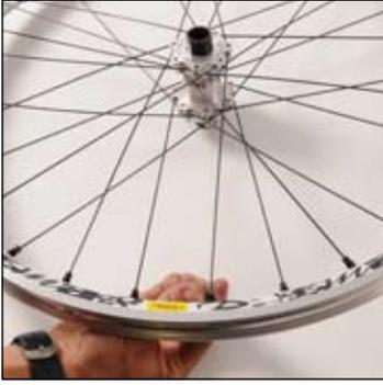
**ブレーキングスポーク** (ハブアックスルの右にあるスロットの**外側部分**)のニップルをバルブ穴の右の**最初の**スポーク穴にロックされるまで回します。
