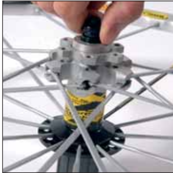
反フリーホイール側のフォークサポートナットを外します。
