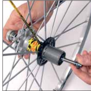
アクスルのフリーホイール側の端のアクスルエンドスクリューを取り外した後、反フリーホイール側からアクスルシャフトを取り外します。
