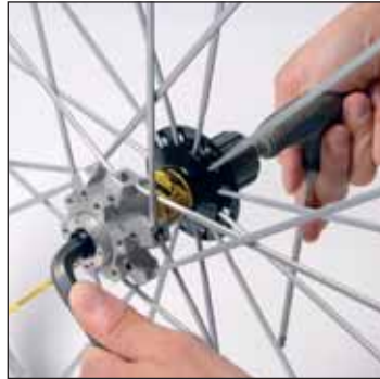
アクスルのフリーホイール側から 5 mm アーレンキーを、反フリーホイール側から 10 mm アーレンキーを差し込み、緩めます。
