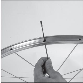
準備として各スポークにニップルをロックするまでねじ込んでおきます。そしてスポークの L 字型の方をハブ側にして、外側から各リム穴に差し込みます。
