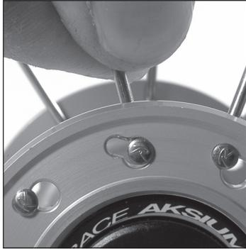
各スポークの L 字型の部分をハブフランジの切り込みに通します。
