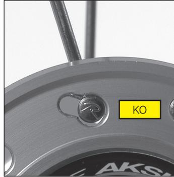
スポークヘッドが正確な位置になるように注意してスポークを締め付け、ホイールのテンションを正しく調整します。
