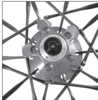
298.5 mm スポーク(324 180 01)を残りのリム穴に入れ、ニップルを 2 回転させて締め付けます。リム穴の並びに沿って、スポークは自然と正しい方向に張られるはずです。
