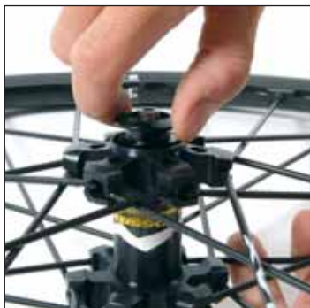
調整ナットを手で回して締め、ハブレンチ M40123 で保持します。
