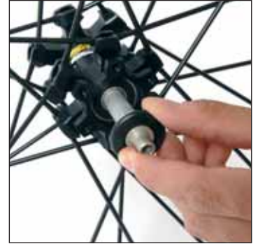
調整ナットを最後まで緩めて、ハブからアクスルを取り外します。
