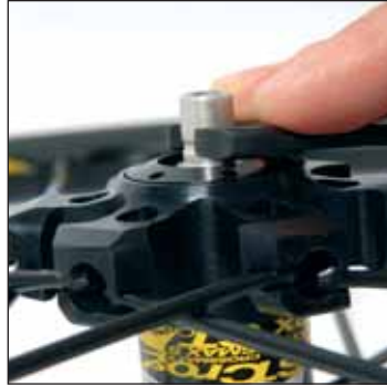
ハブレンチ M40123 で調整ナットを保持します。
