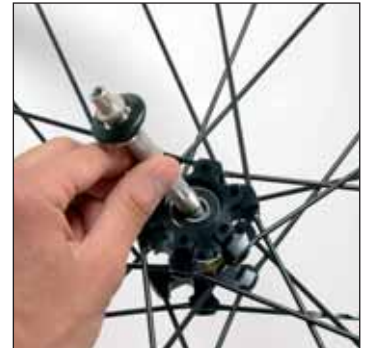
ベアリングカバーをアクスルに再び取り付け、ディスク側からアクスルをハブに再度取り付けます。
