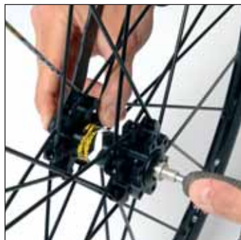
調整ナットの反対側から 5 mm アーレンキーを差し込み、最後まで調整ナットを締め付けた後、1 回転だけ緩めます。
