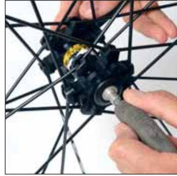
調整ナットの反対側からアクスルに 5 mm アーレンキーを差し込み、調整ナットを緩めます。
