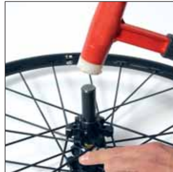
ホイールに合わせてベアリングプレスキット (M40120 または M40373) を使用して、新しいベアリングを取り付けます。
