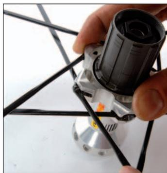
Emboitez les têtes de ces rayons dans les créneaux du moyeu : les têtes des rayons non-tracteurs s'insèrent dans les fentes intérieures des créneaux, celles des rayons tracteurs dans les fentes extérieures.
