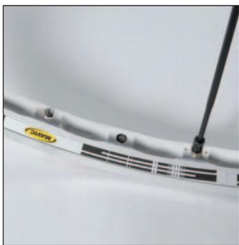
Vissez l'écrou d'un rayon Zical de 2 tours dans le premier trou à droite du trou de valve, puis faites de même pour tous les rayons Zical, 1 trou sur 2 dans la jante.
