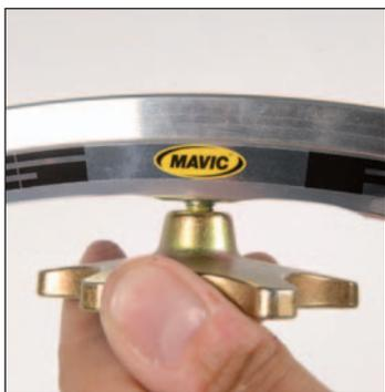
Vissez les écrous des rayons Tracomp dans les trous restants de la jante jusqu'à disparition du frein filet.
