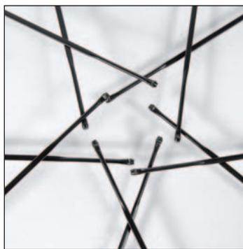
Les perçages de la jante étant orientés, les rayons se positionnent naturellement dans la bonne direction : les rayons non tracteurs doivent passer en-dessous des rayons tracteurs, sans contact au croisement.
