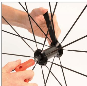
Introduisez la clé 6 pans de 5 mm à l'extrémité de l'axe, côté opposé à l'écrou de réglage. Maintenez l'écrou de réglage à l'aide de la clé à ergots M40123.
