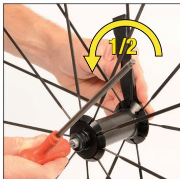
A l'aide de la clef 6 pans et de la clef à ergots M40123, resserrez l'axe (sens des aiguilles d'une montre) jusqu'au contact du roulement et revenez en arrière d'un demi-tour.
