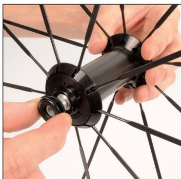
Côté écrou de réglage, retirez l'appui fourche qui est clippé au bout de l'axe.
