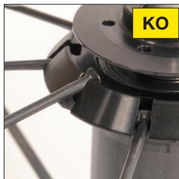
Vissez chacun des écrous uniformément (1 tour de clé à rayon pour chaque rayon et par tour de roue) pour mettre la roue en tension, en vérifiant le bon positionnement de leurs têtes dans le fond de la gorge du moyeu afin de prévenir tout décrochement de rayon ou casse de moyeu.
