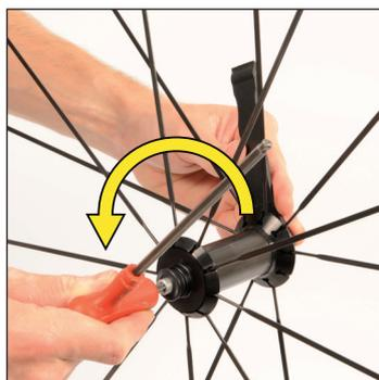
Dévissez l'axe en tournant la clé 6 pans dans le sens inverse des aiguilles d'une montre. Faites environ 5 tours pour libérer suffisamment de jeu.
