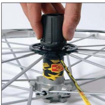
Retirez le corps de roue libre en le faisant tourner dans le sens inverse des aiguilles d'une montre.
