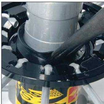
Remplacez le joint à lèvres en butée sur le corps de moyeu en le poussant entre la base et la lèvres à l'aide d'un outil pointu non coupant.
