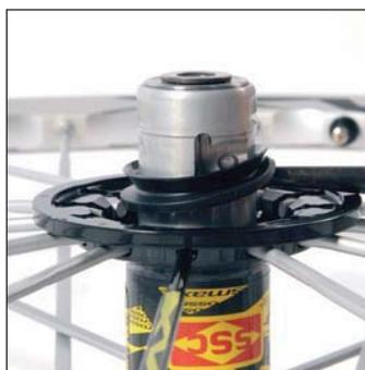
Retirez délicatement le joint à lèvres à l'aide d'un outil pointu non coupant.
