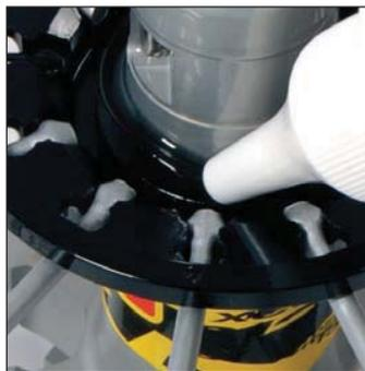
Lubrifiez l'intérieur du corps de roue libre dans la zone dentée de manière à remplir 2 à 3 rainures du corps de roue libre. Déposez également une goutte d'huile minérale Mavic M40122 sur la lèvres du joint.
