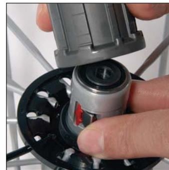
Déposez la rondelle entretoise sur le roulement du corps de moyeu, abaissez les cliquets et remettez en place le corps de roue libre sur le moyeu.
