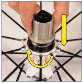
Poussez délicatement le corps de roue libre en exerçant une rotation dans le sens inverse des aiguilles d'une montre.
