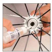
Nettoyez le corps de moyeu et remplissez 3 dents du rochet avec de l'huile 996 136 01 et remontez l'ensemble axe et corps de roue libre.
