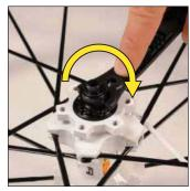
Remontez l'écrou de réglage et l'appui cadre.
