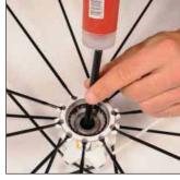
A l'aide du jet de démontage, chassez les deux roulements par l'intérieur. Nettoyez avec un chiffon sec si besoin.
