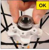
Afin de garantir une parfaite étanchéité du mécanisme de roue libre, les roulements du corps de moyeu doivent être montés avec le joint d'étanchéité côté disque.
