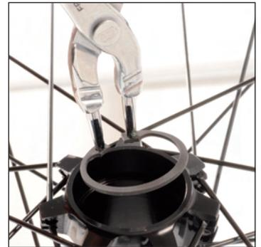
Remontez le circlips par le côté opposé disque à l'aide de la pince à circlips.
