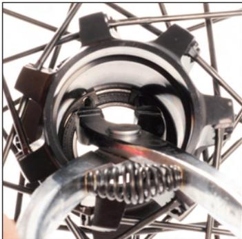
Retirez le circlips par le côté opposé disque à l'aide de la pince à circlips.
