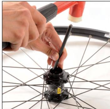
Chassez le roulement côté disque en le poussant à l'aide d'un jet de démontage par l'extérieur du moyeu de manière à extraire le roulement par le côté opposé.
