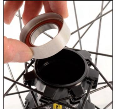
Chassez le roulement côté opposé disque. Le roulement étant emmanché dans une entretoise, il est possible que celle-ci soit chassée avec le roulement. Désolidarisez alors l'entretoise du roulement.
