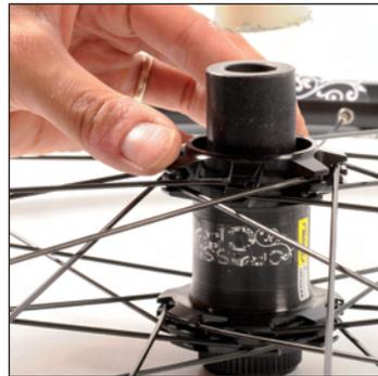
Introduisez le nouveau roulement côté disque par le côté opposé disque et pressez le à l'aide du jet de montage M40218 et d'un tube supplémentaire.
