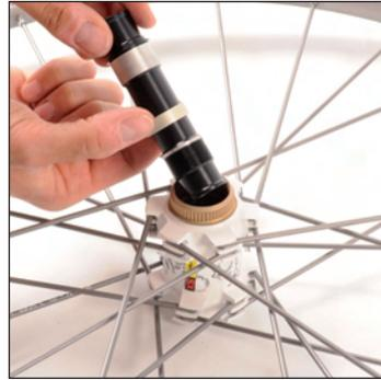
Retirez l'axe. Pour la Crossmax SX, prenez garde à ne pas égarer la rondelle de calage du roulement glissée sur l'axe.
