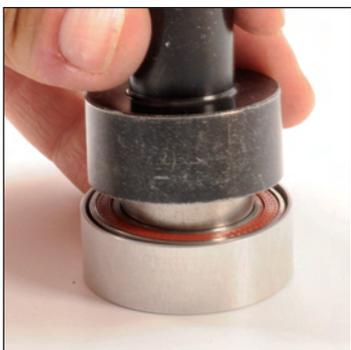
Si lors du démontage, l'entretoise côté opposé disque a été sortie du moyeu, commencez par remonter le nouveau roulement sur l'entretoise à l'aide du jet de montage M40218.
