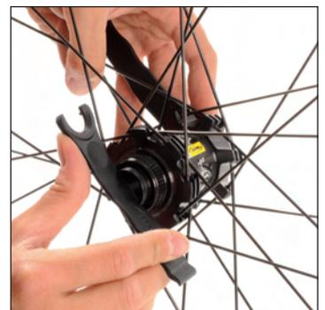
Revissez l'écrou de réglage à l'aide de la clé à ergots, en maintenant l'axe manuellement (Crossmax SX) ou le manche d'une deuxième clé M40123 introduit dans les fentes de l'axe (Crossline) jusqu'au contact du roulement et redévissez-le d'un ¼ de tour.
