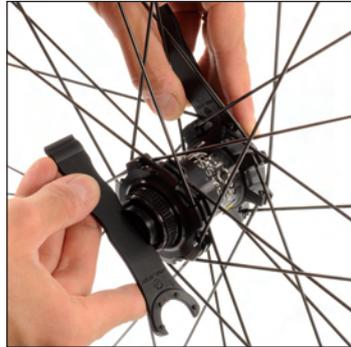
Maintenez la clé M40123 en place et dévissez l'axe par le côté disque avec les doigts (Crossmax SX) ou le manche d'une deuxième clé M40123 introduit dans les fentes de l'axe (Crossline).
