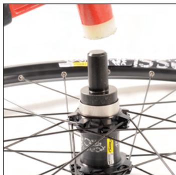
Remontez ensuite l'ensemble roulements-entretoise dans le moyeu côté opposé disque en le pressant à l'aide du jet de montage M40218.
