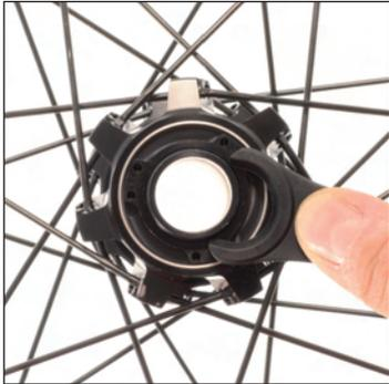
Introduisez les ergots de l'extrémité de la clé M40123 dans 2 trous écartés de l'écrou de réglage côté opposé disque.
