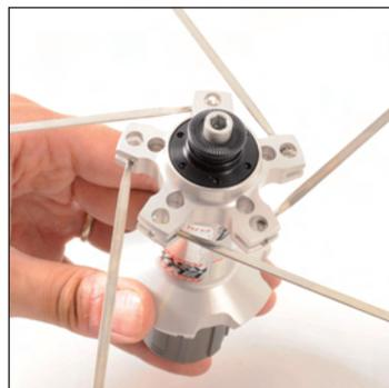
Insérez les têtes de ces rayons dans les créneaux du moyeu côté opposé roue libre. Ces rayons sont non tracteurs.
