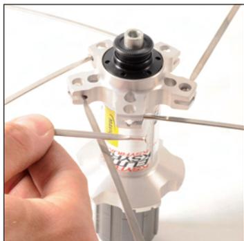
Présentez la tête d'un rayon tracteur en passant sous la jante, sous le 1° rayon non tracteur puis au dessus du 2° rayon non tracteur. Introduisez la tête de ce rayon dans l'encoche du créneau correspondante.
