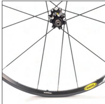
Trou de valve près de vous, insérez ce rayon dans le 1<sup>er</sup> trou à droite du trou de valve et vissez son écrou de 2 tours. Faites de même pour les 6 rayons tracteurs côté opposé roue libre.
