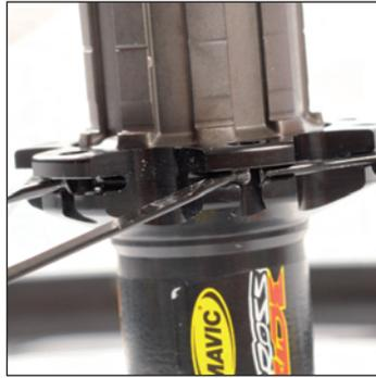
Insérez la tête d'un rayon dans un créneau du moyeu afin que ce rayon soit tracteur.
