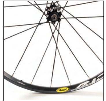
Trou de valve près de vous, insérez ce rayon dans le 3<sup>e</sup> trou à droite du trou de valve et vissez son écrou de 2 tours. Faites de même pour les 6 rayons non tracteurs côté opposé roue libre.
