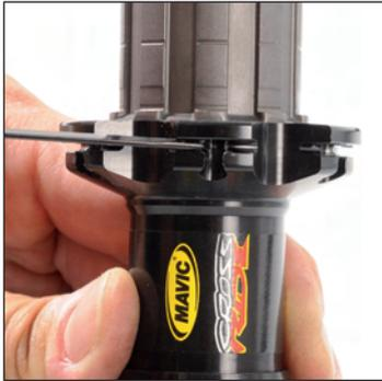
Insérez la tête d'un rayon dans un créneau du moyeu afin que ce rayon soit non tracteur.
