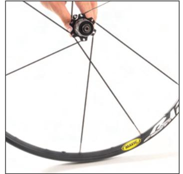
Trou de valve près de vous, insérez ce rayon dans le 3<sup>e</sup> trou à droite du trou de valve et vissez son écrou de 2 tours. Faites de même pour les 6 rayons tracteurs côté roue libre.
