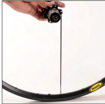
Trou de valve près de vous, insérez ce rayon dans le 1<sup>er</sup> trou à droite du trou de valve et vissez son écrou de 2 tours. Faites de même pour les 6 rayons non tracteurs côté roue libre.
