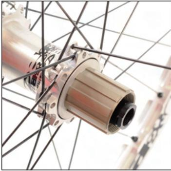
Pour un rayon se positionnant dans un créneau intérieur, présentez sa tête sur le créneau en l'orientant parallèlement à l'axe du moyeu, par l'extérieur de la roue.
