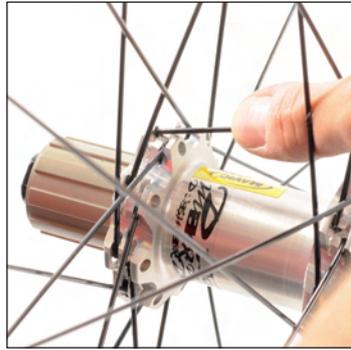
Pour un rayon se positionnant dans un créneau extérieur, présentez sa tête sur le créneau en l'orientant parallèlement à l'axe du moyeu par l'intérieur de la roue.
