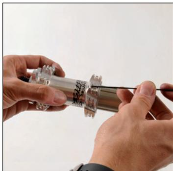
Présentez la tête d'un rayon sur un créneau en l'orientant parallèlement à l'axe du moyeu, par l'extérieur de la roue.
