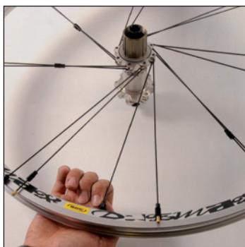
Vissez jusqu'à son freinage l'écrou d'un rayon **non tracteur** (partie **intérieure** d'un créneau à droite de l'axe du moyeu) dans le 1<sup>er</sup> trou à droite du trou de valve.
