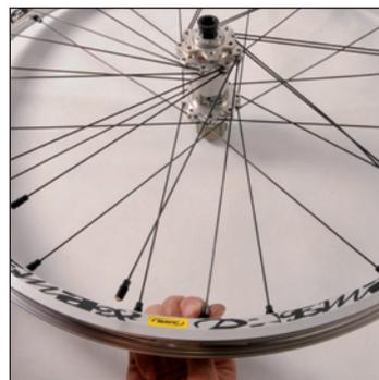
Vissez jusqu'à son freinage l'écrou d'un rayon **tracteurs** (partie **intérieure** d'un créneau à droite de l'axe du moyeu) dans le 1<sup>er</sup> trou à droite du trou de valve.
