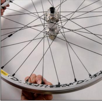
Vissez jusqu'à son freinage l'écrou d'un rayon **non tracteur** (partie **extérieure** d'un créneau à gauche de l'axe du moyeu) dans le 3<sup>e</sup> trou à droite du trou de valve.
