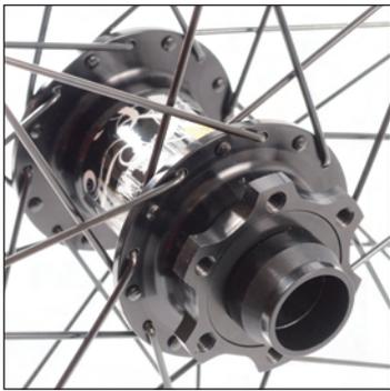
Sur la roue avant des 2 côtés, les coudes des rayons freineurs doivent être orientés vers l'extérieur des flasques du moyeu.
