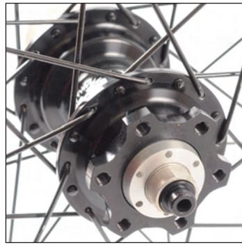
Sur la roue l'arrière côté opposé roue libre, les coudes des rayons tracteurs doivent être orientés vers l'intérieur du flasque du moyeu.
