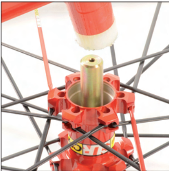
Introduisez le nouveau roulement côté disque (le plus petit des 2) par le côté opposé disque et pressez le à l'aide du jet de montage 996 887 01.
