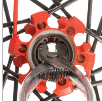
Chassez le roulement côté opposé disque puis retirez le circlips par le côté opposé disque à l'aide de la pince à circlips.
