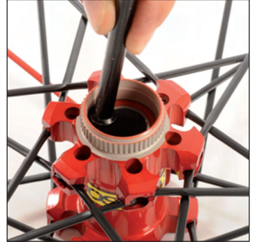
chassez le roulement côté disque en le poussant à l'aide d'un jet de démontage par l'extérieur du moyeu de manière à extraire le roulement par le côté opposé.
