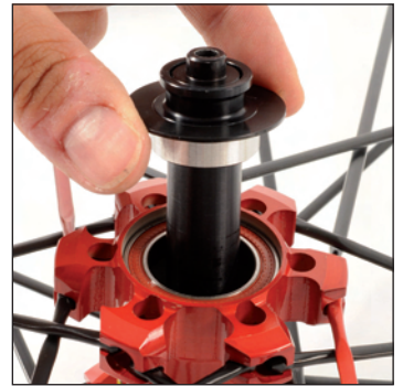
Remontez l'axe sur le moyeu par le côté opposé disque, revissez l'écrou de réglage à l'aide de la clé à ergots jusqu'au contact du roulement et redévissez-le d'un ¼ de tour.
