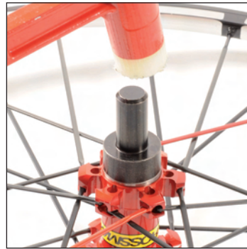
Montez le nouveau roulement côté opposé disque à l'aide du jet de montage M40218.
