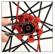
Dévissez le capot de protection des roulements côté opposé disque à l'aide de la clé à ergots.
