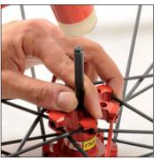
Chassez les roulements à l'aide du jet de démontage des roulements.
