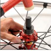
Remontez les roulements à l'aide du jet de montage des roulements 323 945 01 (côté opposé disque) et M40218 (côté disque).
