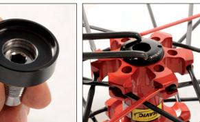
Remontez le capot de protection du roulement à l'aide de la clé à ergot (couple 9 Nm).
