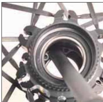
Introduisez un jet de démontage par le côté disque et chassez le roulement côté opposé disque vers l'extérieur (prenez soin de ne pas endommager le circlips à proximité du roulement)
