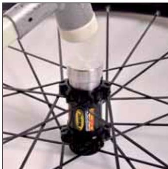
A l'aide du jet de montage 996 887 01, montez le nouveau roulement côté opposé disque
