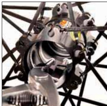
Depuis le côté opposé disque, à l'aide d'une pince à circlips intérieur, remonter le deuxième circlips intérieur (côté disque) dans sa gorge puis le premier circlips intérieur (côté opposé disque) dans sa gorge
