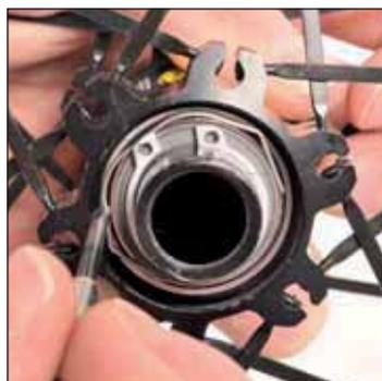
Maintenez une pression sur l'axe côté opposé disque et dans le même temps, à l'aide d'un tournevis, appuyez sur l'épingle en 3 points (2 extrémités + centre) pour faire glisser celle-ci vers l'intérieur
