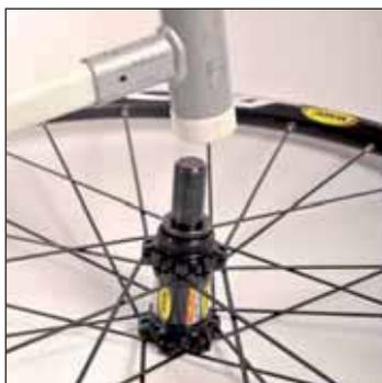
Par le côté disque, à l'aide de jet de démontage 108 850 01, chassez le roulement côté disque vers l'extérieur
