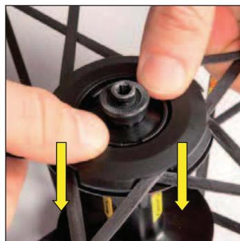
Placez vos pouces sur deux bords opposés du capot et appuyez pour clipper le capot sur le corps de moyeu.
