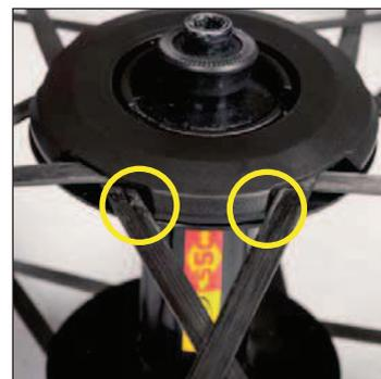
Vérifiez le bon positionnement du capot. Attention : Le capot ne doit pas être en contact avec les rayons.
