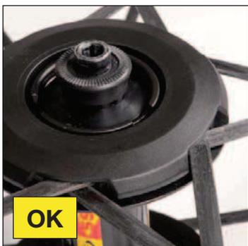
Positionnez le nouveau capot en vérifiant que les dents de celui-ci ne soient pas en contact avec les rayons.
