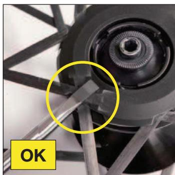
Insérez un tournevis plat (idéalement 5 x 125mm) dans une ouverture au niveau du croisement de deux rayons, poussez-le jusqu'à ce que le bout du tournevis soit en butée sur le corps du moyeu.
