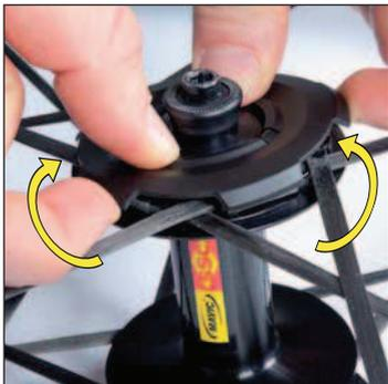
Déclipsez l'ancien capot de moyeu en appuyant sur l'intérieur avec vos pouces et soulevez le pour le retirer.
