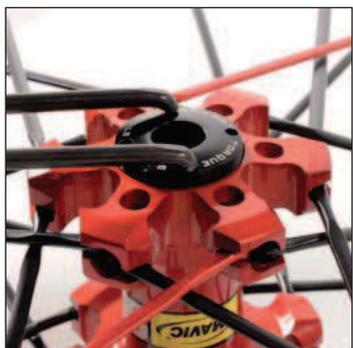
Remontez le capot de protection du roulement à l'aide de la clé à ergot (couple 9 Nm).
